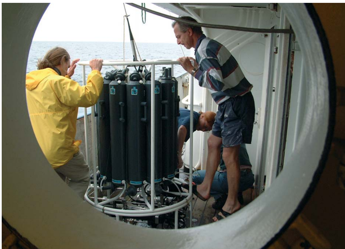
GMFs CTD-sond är ett av de instrument som ställs till forskningens förfogande på GMF. Här görs instrumentet i ordning för automatisk och kontinuerlig mätning av salthalt, temperatur och djup under sin färd ner genom vattenmassorna.
